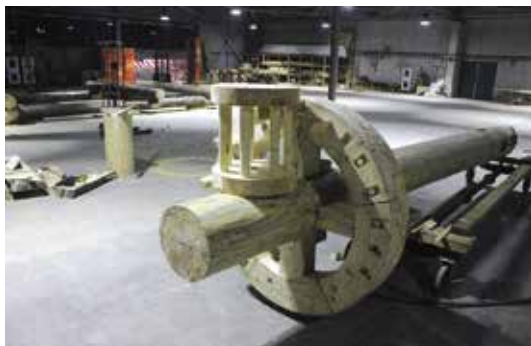
Ил. 3. Горизонтальный вал поворотного мельничного механизма в сборе с ведущей и ведомой шестернями
